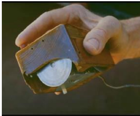
Figura 7-1 – O primeiro rato de Douglas Engelbart (Fonte: Mouse Site 272 )
