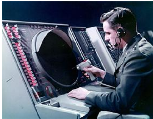
Figura 3-2 – Interação com o sistema SAGE. Monitor e caneta luminosa. (Fonte: Computer History Museum)
