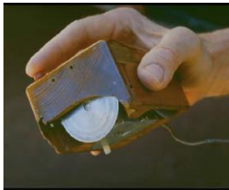
Figura 3-9 – O primeiro rato de Douglas Engelbart (Fonte: Mouse Site 93 )
