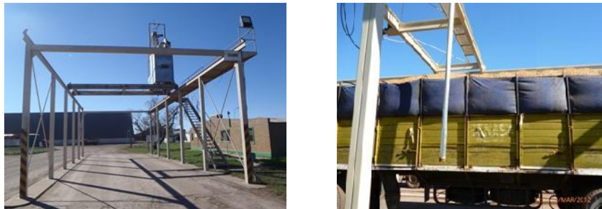
Figura 17: Muestreador neumático empleado en el muestreo de maní en caja
