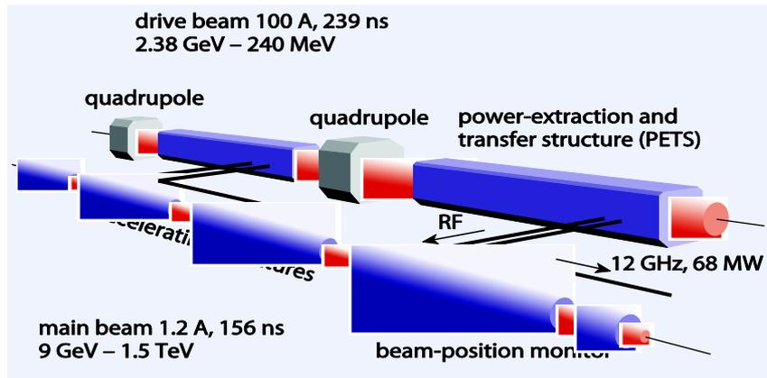
Figura 2.- Esquema de doble haz en CLIC: la potencia RF necesaria para acelerar el haz principal (“Main Beam”) hasta el orden de los TeVs es proporcionada por el haz secundario (“Drive Beam”), de menor energía pero mayor corriente.
