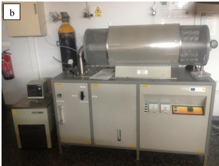
Figura 23: Ciclo de sinterizado SIN1250 (a) y horno Carbolite, modelo HVT 15/75/450 (b) empleado en la etapa de sinterización
