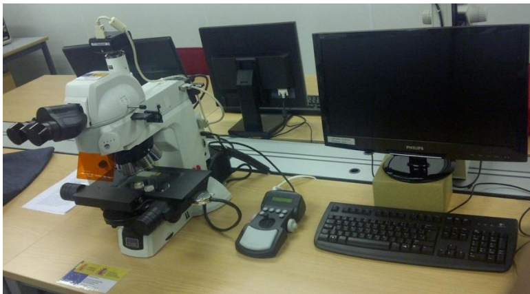
Figura 34: Microscopio óptico Nikon LV-100
