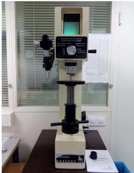
Figura 29: Equipo Centaur utilizado para la medición de la dureza
