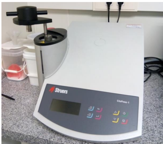
Figura 31: Equipo Citopress-1 utilizado para la embutición de las muestras
