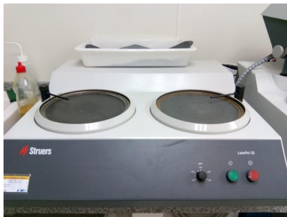
Figura 32: Equipo Labopol-25 utilizado para el desbaste de las muestras
