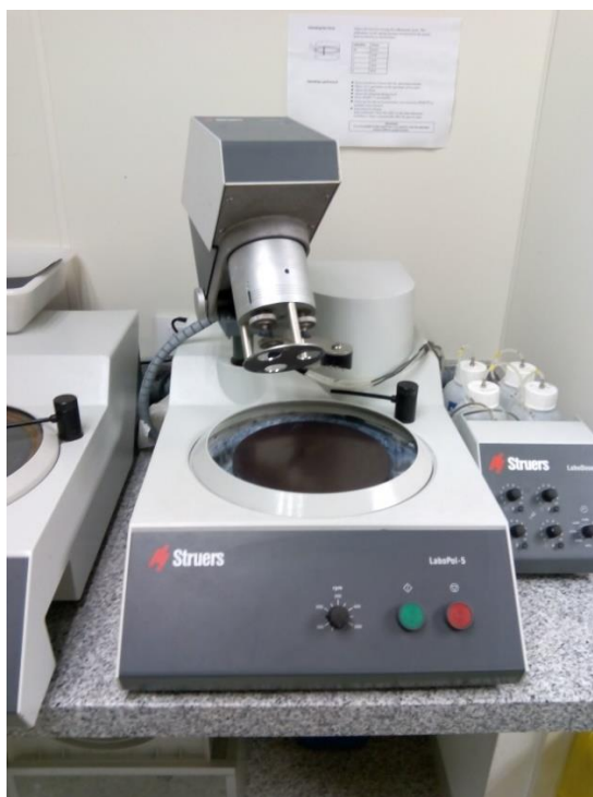
Figura 33: Equipo Labopol-5 utilizado para el desbaste con pasta de diamante de las muestras
