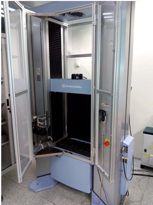
Figura 26: Equipo Shimadzu utilizado para realizar el ensayo de flexión
