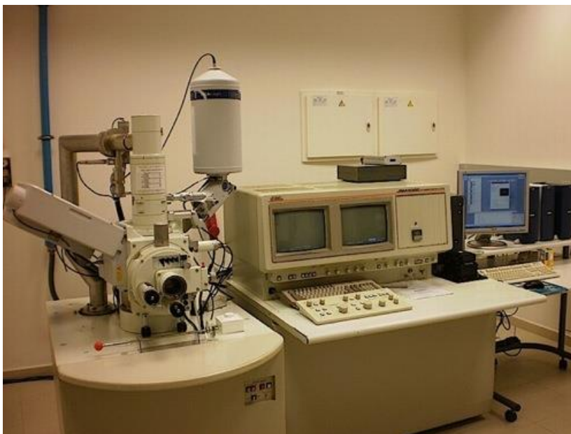
Figura 36: Equipo JEOL JSM 6300 utilizado para la observación de las muestras por SEM
