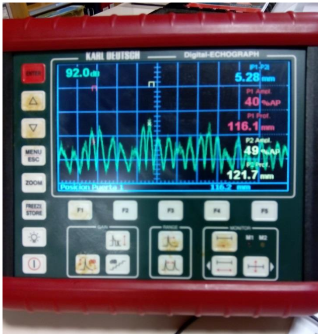
Figura 28: Equipo Karl Deusch Echograph 1090 utilizado para realizar el ensayo de ultrasonidos
