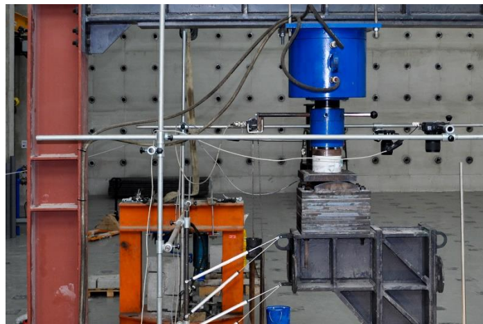
Figura IV-14. Vista del actuador hidráulico y encoder
