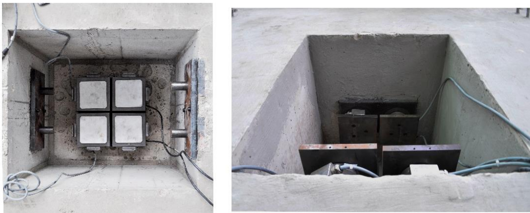
Figura IV-10. Detalle del utillaje empleado en el interior del hueco del cáliz
