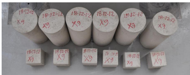
Figura IV-20. Probetas para el control de resistencia del hormigón
