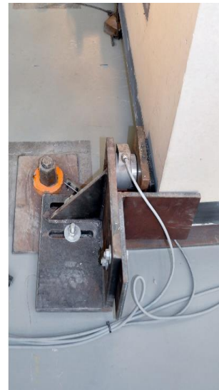
Figura IV-26. Posicionamiento de especímenes y detalle de topes en esquinas
