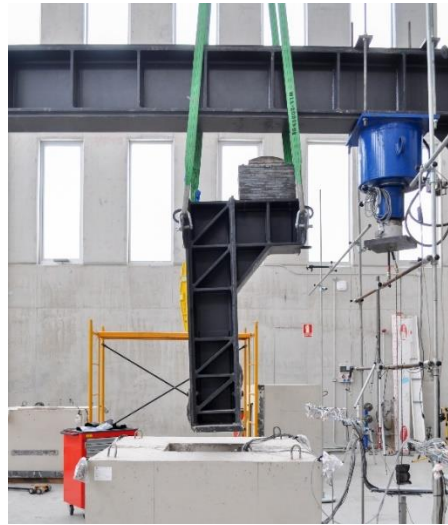
Figura IV-28. Posicionamiento del pilar
