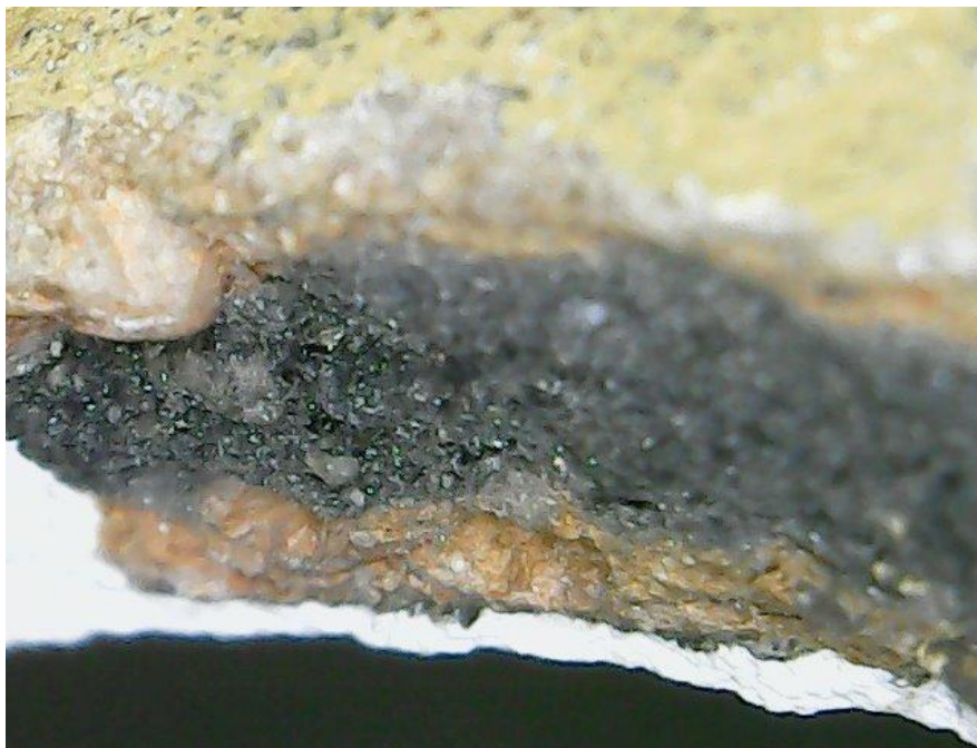
Imagen 13. Estratigrafía, se aprecia la superficie pintada durante la intervención de color ocre, por el contrario, en la parte interna (inferior de la foto) se aprecia la capa de yeso invadiendo pieza original. Fuente: Macrofotografía de estudio.
