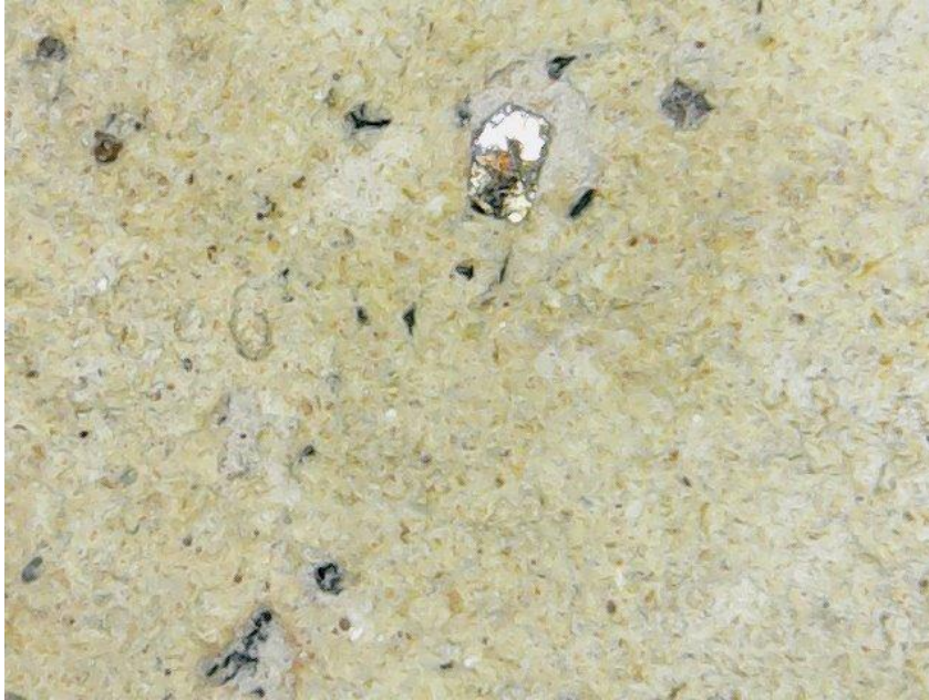
Imagen 5. Superficie del Ánfora, posible pirita como parte de la composición. Fuente: Macrofotografía de estudio.
