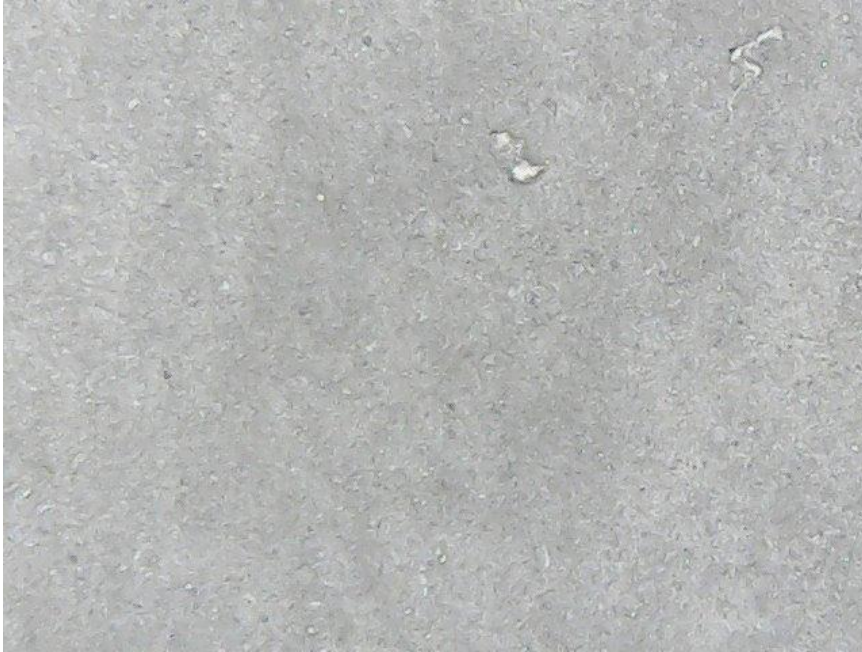
Imagen 10. Textura regular de la superficie de la zona reintegrada. Fuente: Macrofotografía de estudio.
