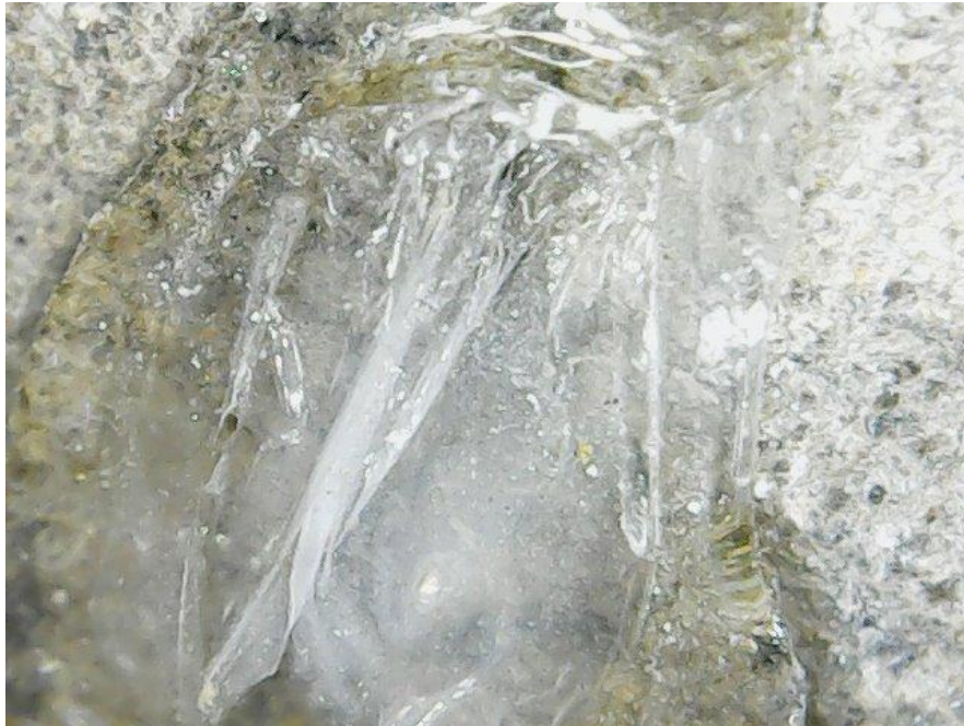
Imagen 12. Exceso de adhesivo en la superficie de la pieza. Fuente: Macrofotografía de estudio.
