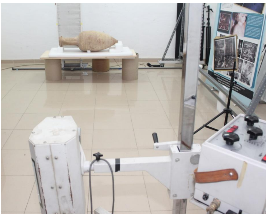
Imagen 2. Posición y distancia a la que se realizó la radiografía digital mediante técnica del DLR. Al fondo se puede ver el Dispositivo Easylift de AGFA. Fuente: Fotografía de estudio. Laboratorio de Inspección Radiológica, del Instituto Universitario para la Restauración del Patrimonio, en la Universidad Politécnica de Valencia.
