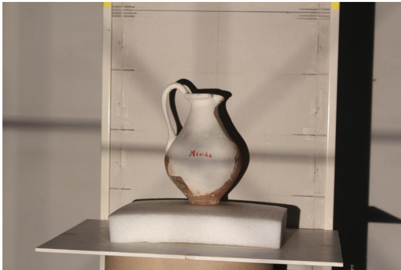
Imagen 16. Pieza expuesta a los rX, Se aprecia la luz marcando el centro de esta. Detrás vemos el Dispositivo Easylift de AGFA. Laboratorio de Inspección Radiológica, del Instituto Universitario para la Restauración del Patrimonio, en la Universidad Politécnica de Valencia. Imágenes de la pieza. Fuente: Fotografía de estudio.
