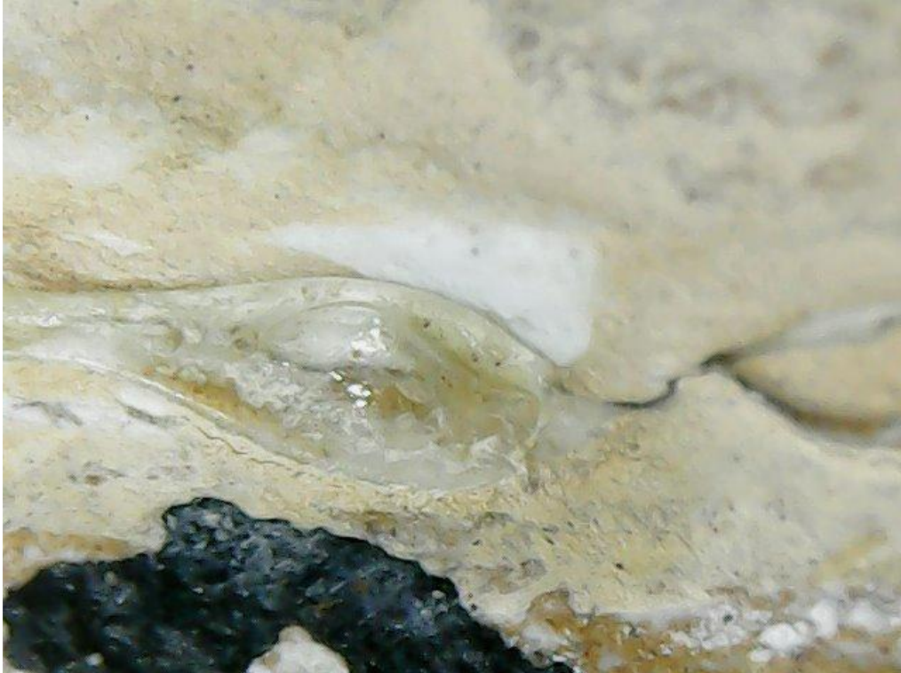
Imagen 21. Detalle de adhesivo sobresaliendo de la superficie. Macrofotografía de estudio.
