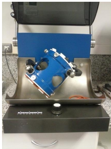
Figura 5.2. Túbula inversina taumelmischer para la mezcla elemental de polvos
