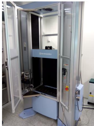
Figura 5.7. Equipo Trapezium, Shimadzu utilizado para realizar el ensayo de flexión
