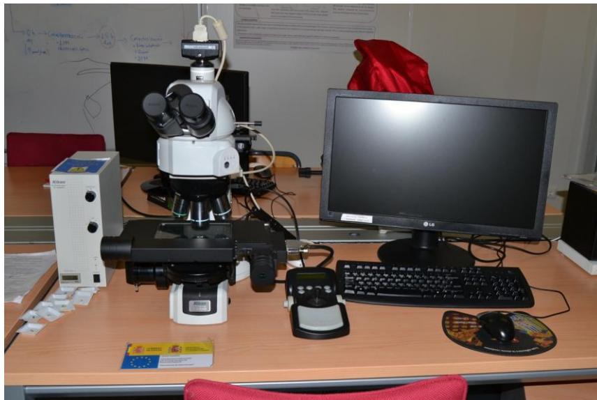
Figura 5.12. Microscopio Nikon LV100 utilizado para la determinación de la porosidad
