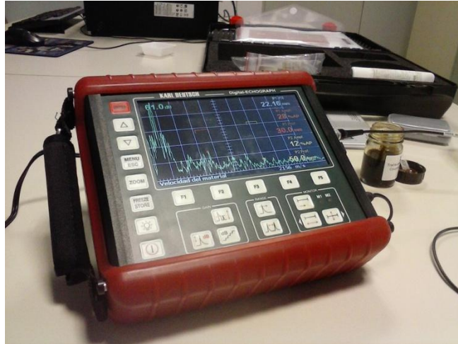
Figura 5.6. Detector de defectos por ultrasonidos Karl Deusch Echograph 1090
