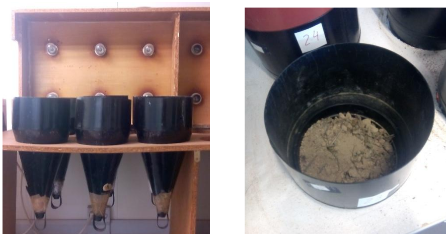
Figura 2. Detalle de los embudos de Berlese para la extracción de los ácaros de las muestras de suelo.
