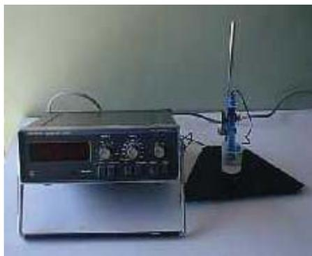
Figura 18. Potenciómetro
