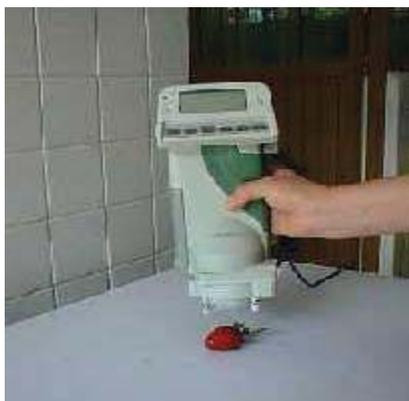
Figura 22. Espectrofotómetro (Minolta 506-d)
