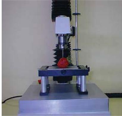
Figura 11. Prueba de Punción
