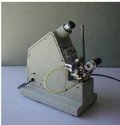
Figura 17. Refractómetro de Abbe (Baush & Lomb)
