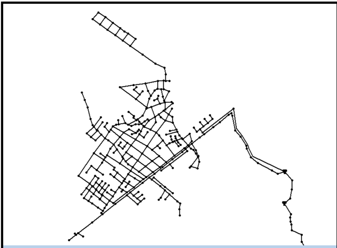
Figura 25. Solución planteada para la población futura, las 4 plantas de lavado de la comunidad actual de Tegucigalpa. (EPANET)
