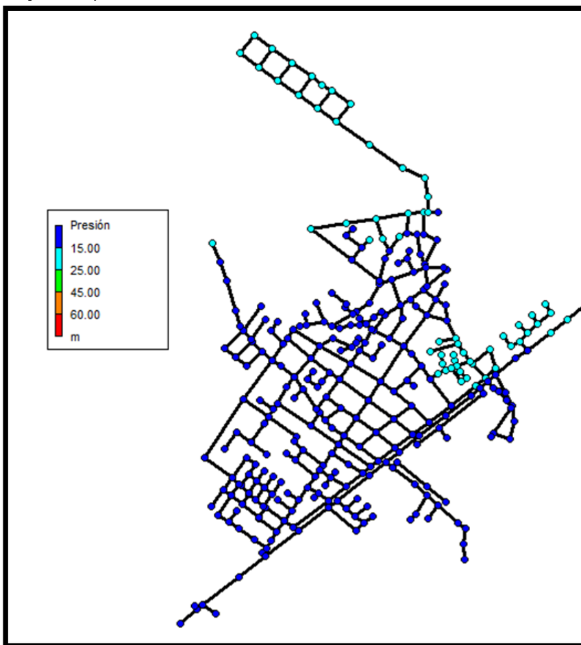
Figura 23. Diagnóstico de presiones de la población futura, las 4 plantas de lavado más la población actual de Tegucigalpa. (EPANET)
