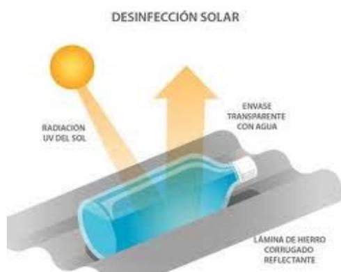
**Figura 1. 8** Desinfección solar método SODIS
