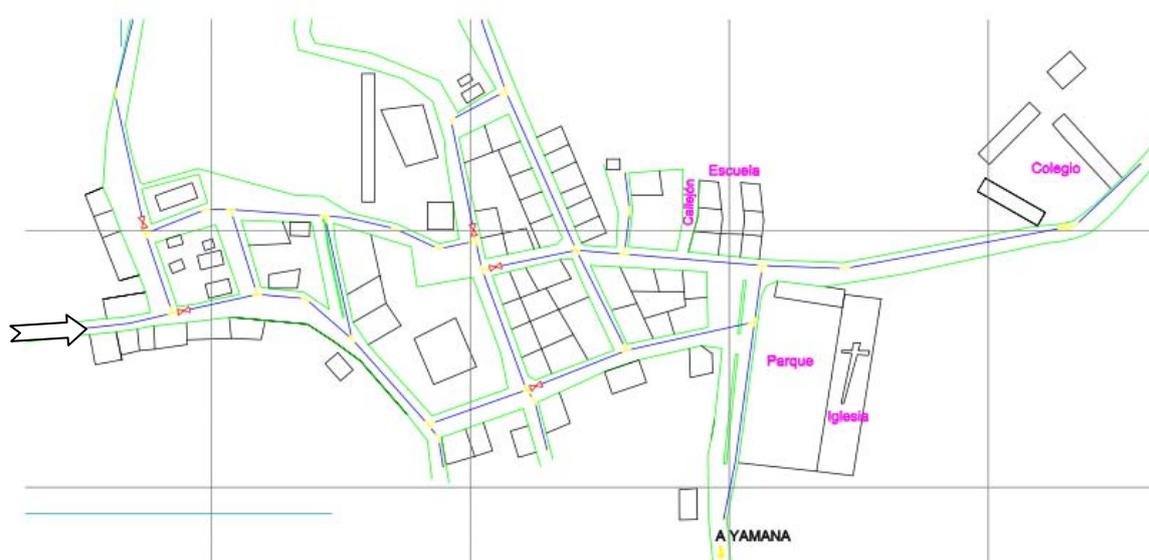
**Figura 5. 13** Esquema de red de distribución existente
