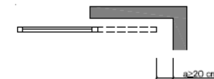
Figura 2.1 Holgura para evitar atrapamientos
