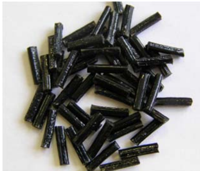
Figura 92. Pellets de fibra larga combinando PP virgen con PP + 1%NTC
