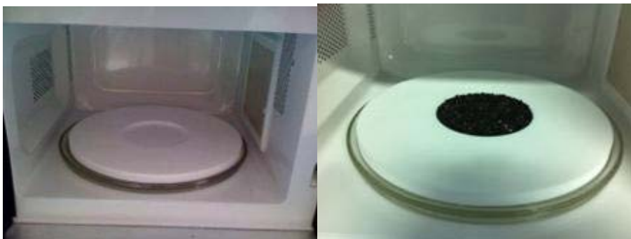
Figura 22. Molde de teflón para contener los pellets en la cavidad del microondas
