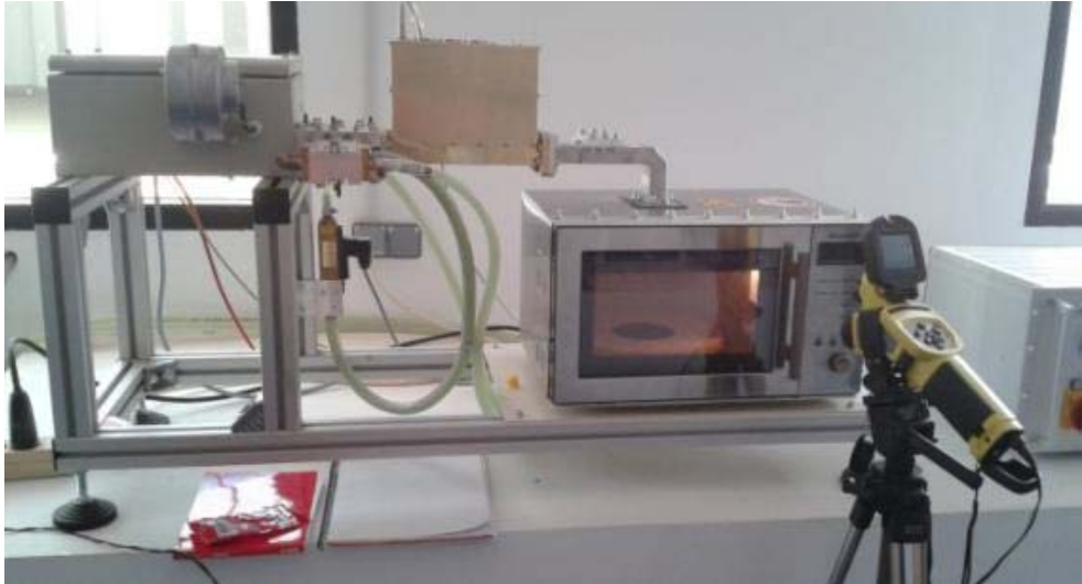
Figura 21. Microondas multimodo de laboratorio de frecuencia 5.8 GHz y disposición de la cámara termográfica
