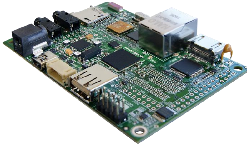
Ilustración 5: IGEP V2, ordenador compacto usado en anteriores proyectos
