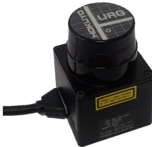
Ilustración 6: Sensor óptico de posición Hokuyo URG-04LX
