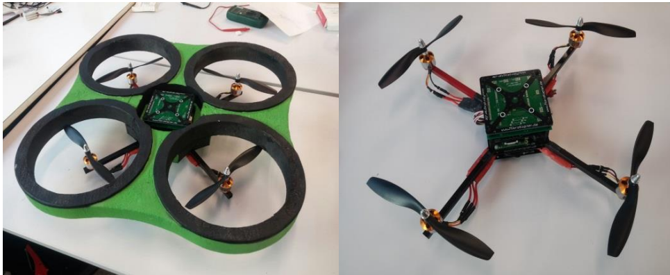
Ilustración 20: Quadrotor con (izquierda) y sin estructura de seguridad (derecha)
