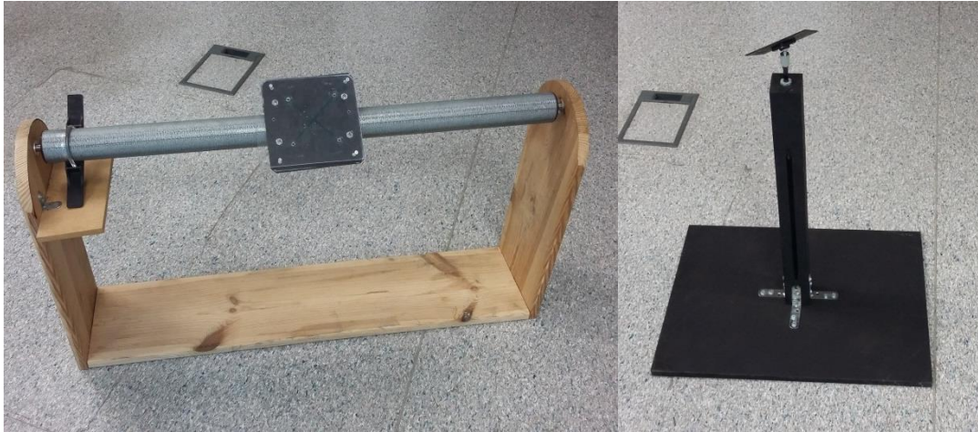
Ilustración 21: Antigua plataforma de ensayo (izquierda). Nueva plataforma desarrollada este año (derecha)
