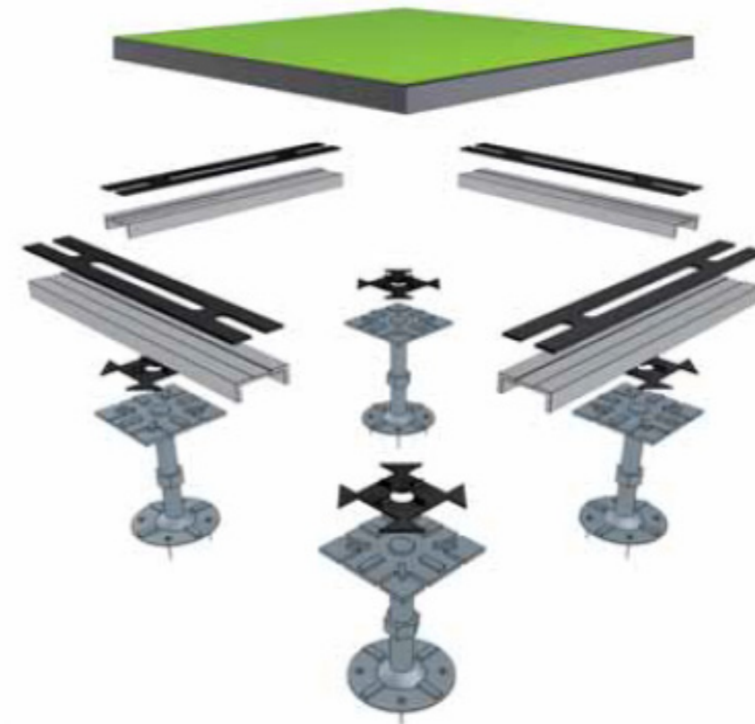
ESQUEMA 2.1. Partes de un pavimento técnico.
