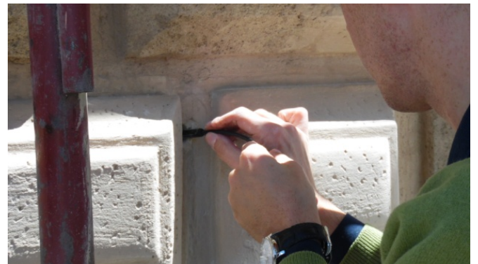
Fig.10 Introduzione dell'endoscopio per l'ispezione del foro.
