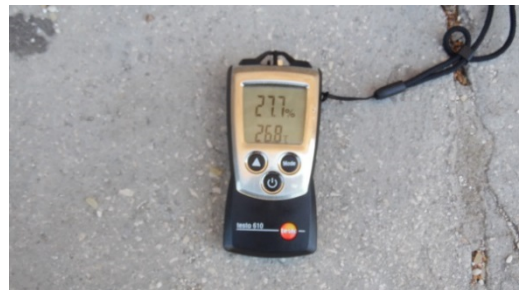
Fig.2 Seconda misura di temperatura e umidità Fonte propria
