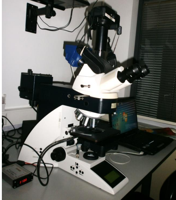
Figura 8. Microscopio de epifluorescencia (DM4500B, Leica, Alemania) con pletina termostatzada, cámaras digitales adaptadas Jenoptik ProgRes CF CCD (Jenoptik AG, Jena, Alemania) y Canon EOS 400D, con objetivos y filtros adecuados para evaluación de integridad de membrana, motilidad, morfometría, y HOST con tinción múltiple, controlados por un ordenador con software para cada fin.
