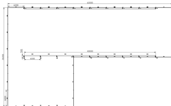
Fig. 16. Vista de las vigas carrileras
