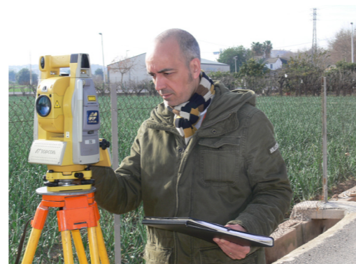
Figura 8. Preparando la estación total. Autor Propio 2015
