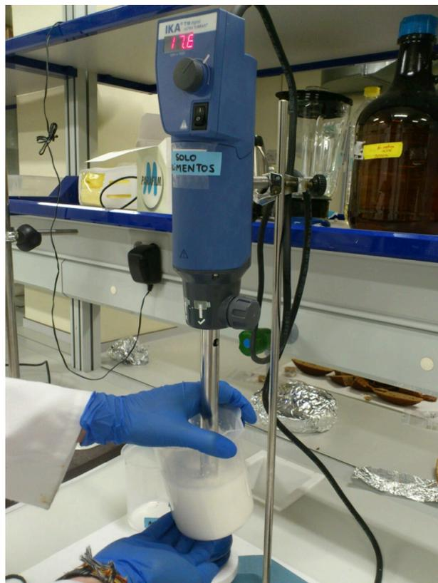
**Figura 4 Proceso de homogenización de la emulsión con ultraturrax.**
