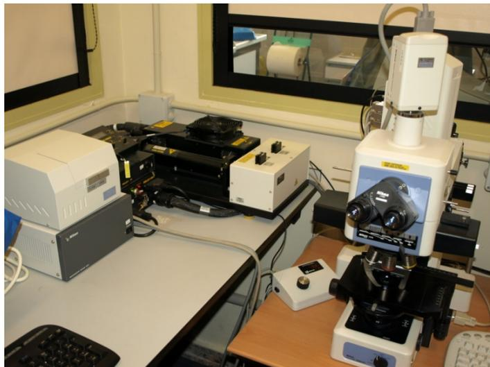
**Figura 7** Microscopio óptico Nikon Eclipse E800 V-PS100E con microscopio láser confocal Nikon C1 acoplado (Nikon, Tokio, Japón).
