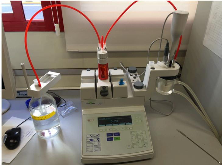
**Figura 6** Valorador automático Mettler-Toledo DL50.
