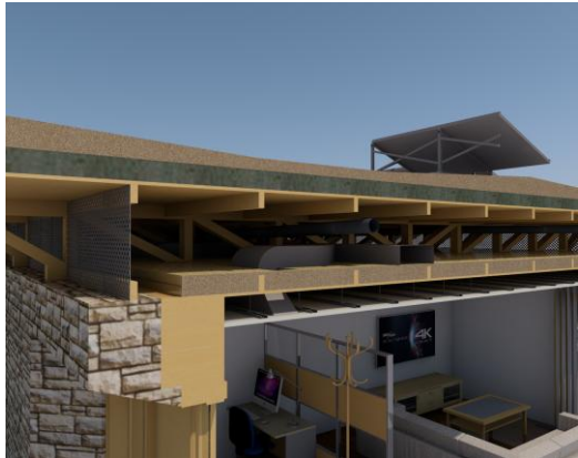
Ilustración 24. Detalle cubierta 2. 2016. Fuente propia
