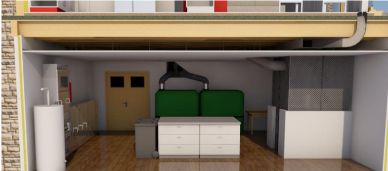
Ilustración 53. Depósitos de agua en el semisótano. 2016 Fuente propia
