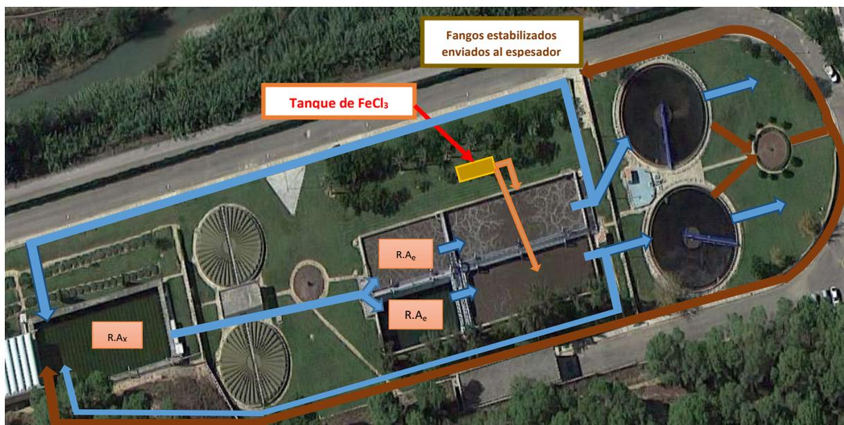
*Figura 35. Alternativa 4: Proceso de oxidación total con eliminación biológica de nitrógeno y precipitación química de fósforo. Esquema Ludzack – Ettinger modificado utilizando la balsa de homogenización como zona anóxica.*
