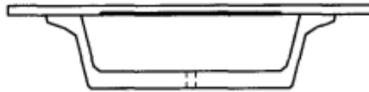
Fig. 9. Sección tipo Viga artesa.
