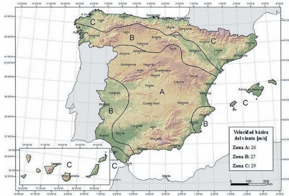
Fig. 41. Mapa de isotacas para la obtención de la velocidad básica fundamental del viento  $V_{b,0}$ .
