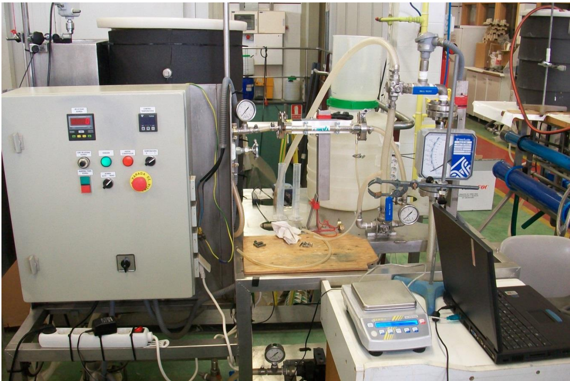
FIGURA 15. Planta piloto de ultrafiltración para ensayos con membranas inorgánicas (Departamento de Ingeniería Química y Nuclear, UPV)
