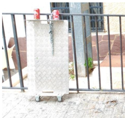
Imagen 2.54 Rampa usada para la accesibilidad al metro de PMR
