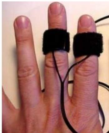
*Figura 7 Colocación de los electrodos para la obtención de la señal EDA (Peuscher, 2012)*
