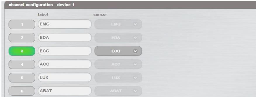
Figura 14 Configuración del almacenamiento de las señales en los canales
