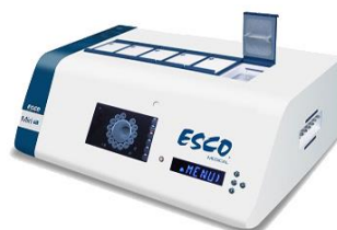
Figura 8. Incubador con tecnología time-lapse incorporada Miri® Time Lapse (Esco, Singapur) (Fuente: http://escoglobal.com/images/upload/MRI-TL_BIG.jpg )
