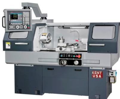
Figura 1-1. Torno CNC<sup>1</sup>.
