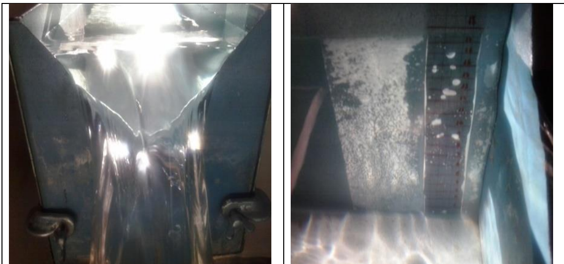
Figura II.3: Izquierda: Vista frontal de la lámina de agua, vertedero triangular. Derecha: Lectura del nivel de agua dentro del canal.
