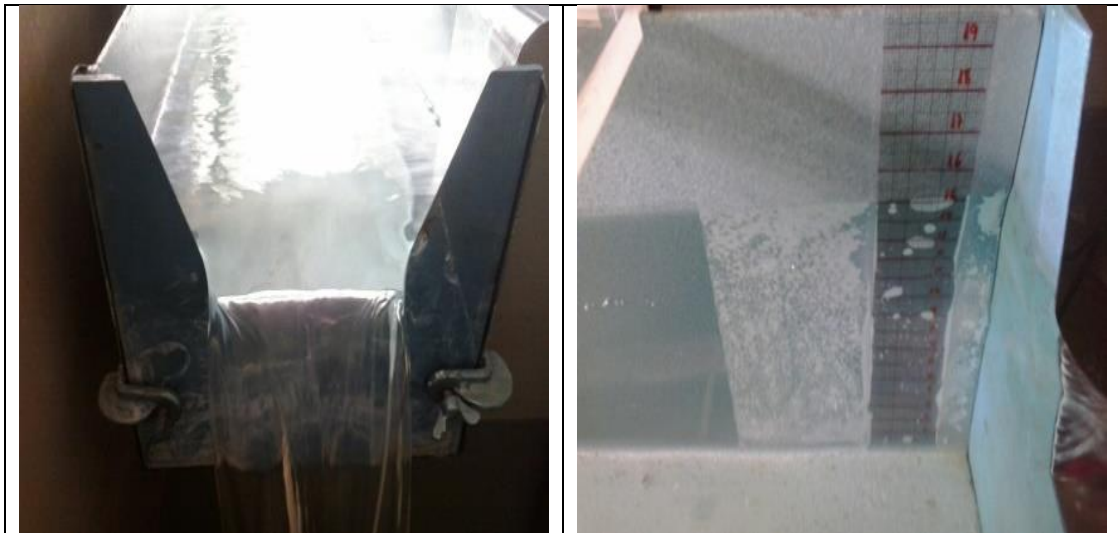
Figura II.5: Izquierda: Vista frontal de la lámina de agua, vertedero trapezoidal. Derecha: Lectura del nivel de agua dentro del canal.
