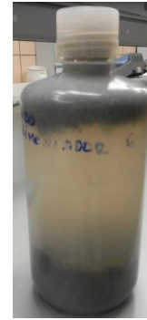
Figura N° 32: Flotación de fangos en el sedimentador.
