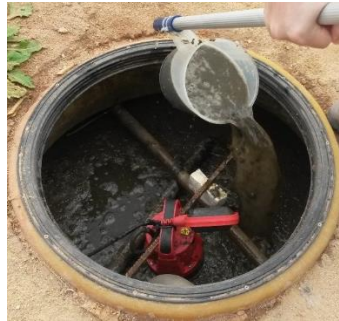
Figura N° 35: Fangos flotantes en el monitoreo.
