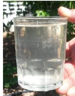
Figura N° 40: Turbidez en el efluente del humedal artificial.
