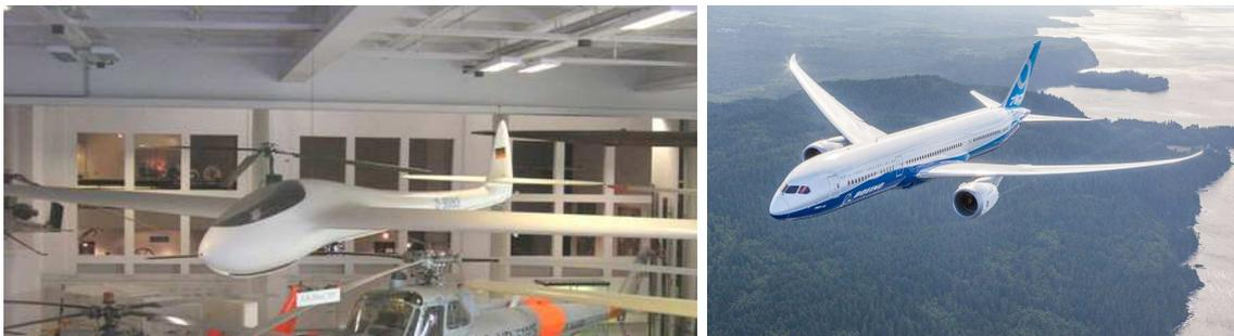
Figura 1.5: Primer avión en incluir material compuesto, FS-24 (Izq.) junto al B-787 (Dcha.), construido al 50% con materiales compuestos; cfr. [43] y [44].
