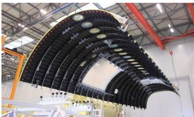
Figura 5.1: Fragmento de fuselaje semimonocasco constituido por láminas reforzadas, cfr. [46].
