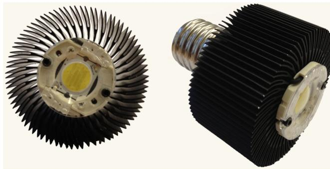
Figura 4.1: Vista frontal y lateral de la bombilla prototipo [3].
