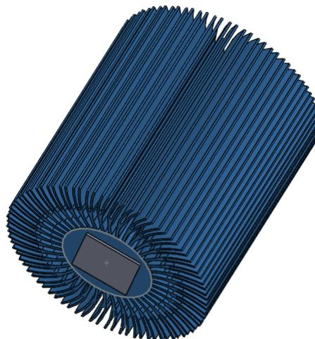
Figura 3.4: Ensamblaje chip y disipador en Solidworks®.
