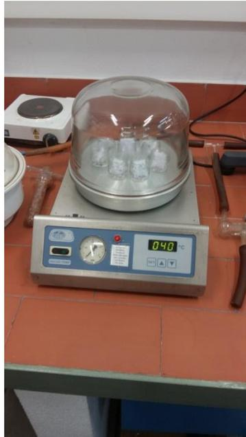
Figura 3.6. Muestras a vacío a 40 °C
