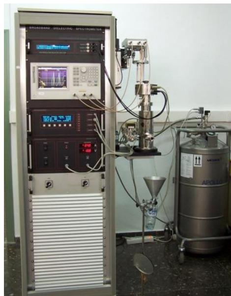
Figura 3.5. Imagen del equipo Novocontrol Concept 80.
