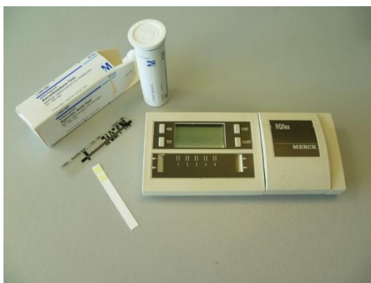
Figura 13. Reflectómetro portátil RQflex plus de Merck y test de ácido ascórbico usado.
