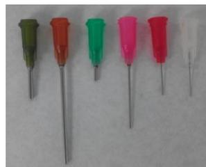
Figura 3.4: Agujas empleadas para determinar la tensión superficial, ordenadas de mayor a menor diámetro externo.
