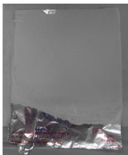
Figura 3.2: Membrana electrohilada.
