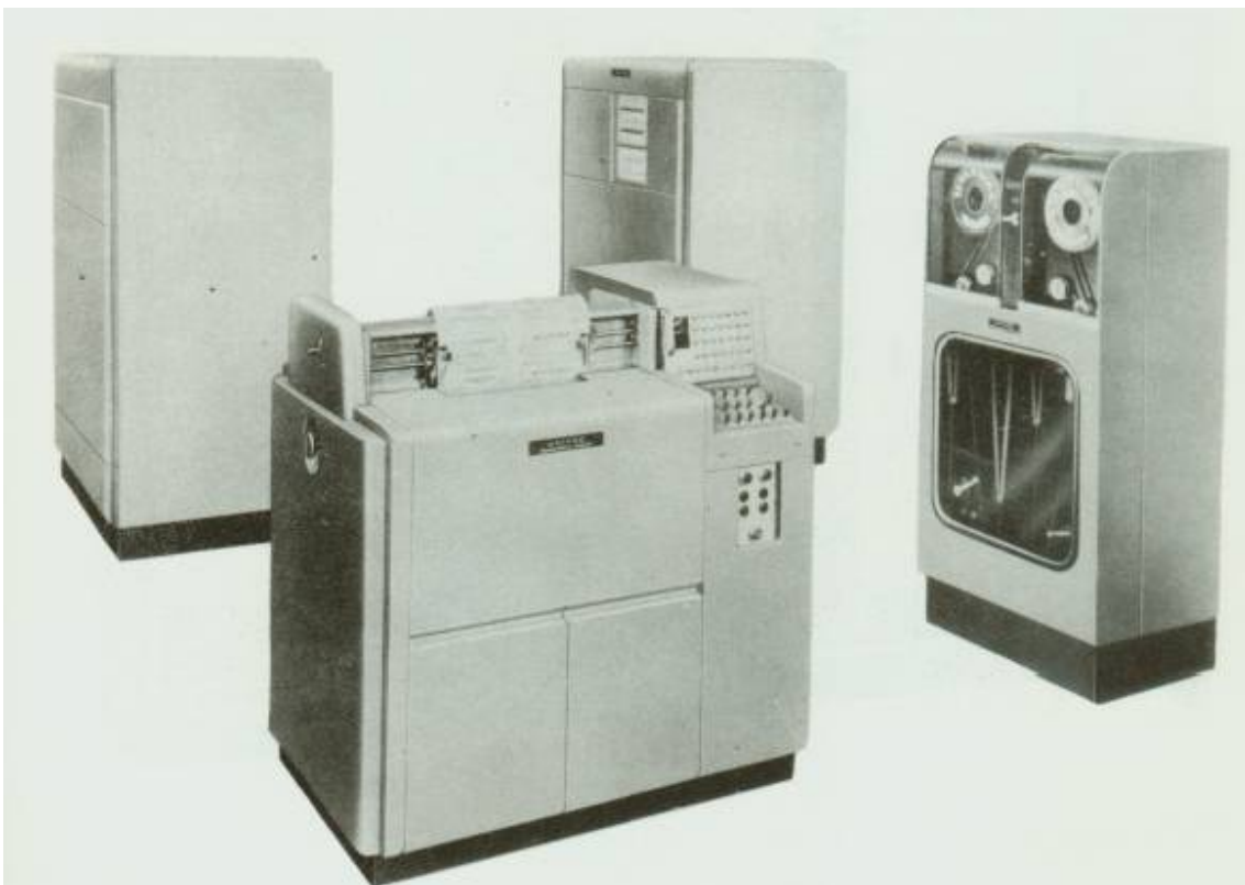
Figura 3.14: Impresora del UNIVAC junto al lector de cintas magnéticas
