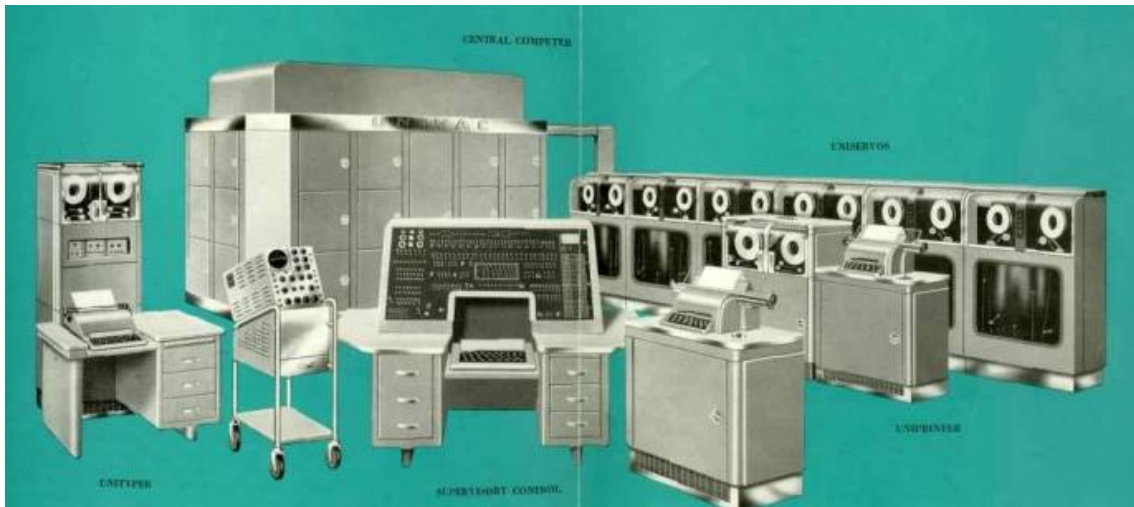
Figura 3.9: Esquema completo del UNIVAC
