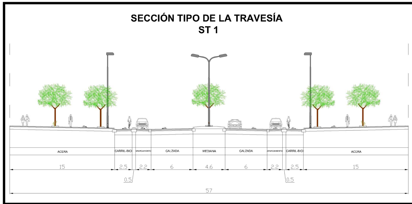
Figura 1. Sección tipo de la alternativa 2 desarrollada en este anteproyecto.
