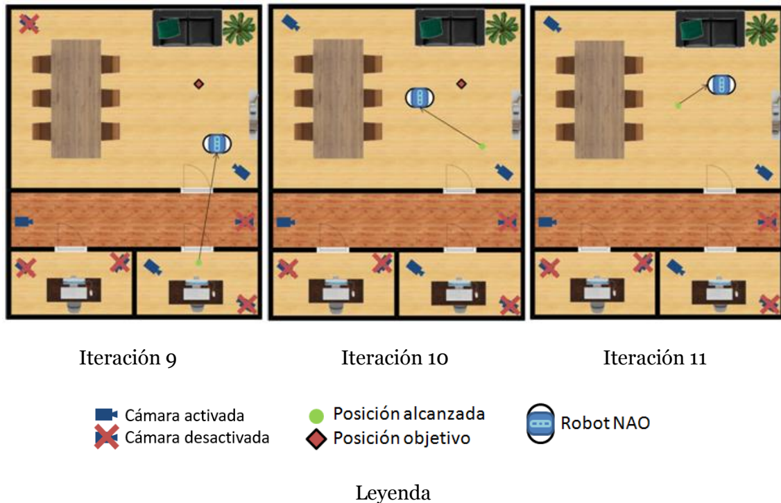
Figura 2 - Movimiento del robot NAO con corrección mediante cámaras
