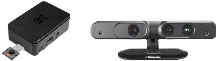
Raspberry Pi 2 con cámara integrada Xtion PRO LIVE
