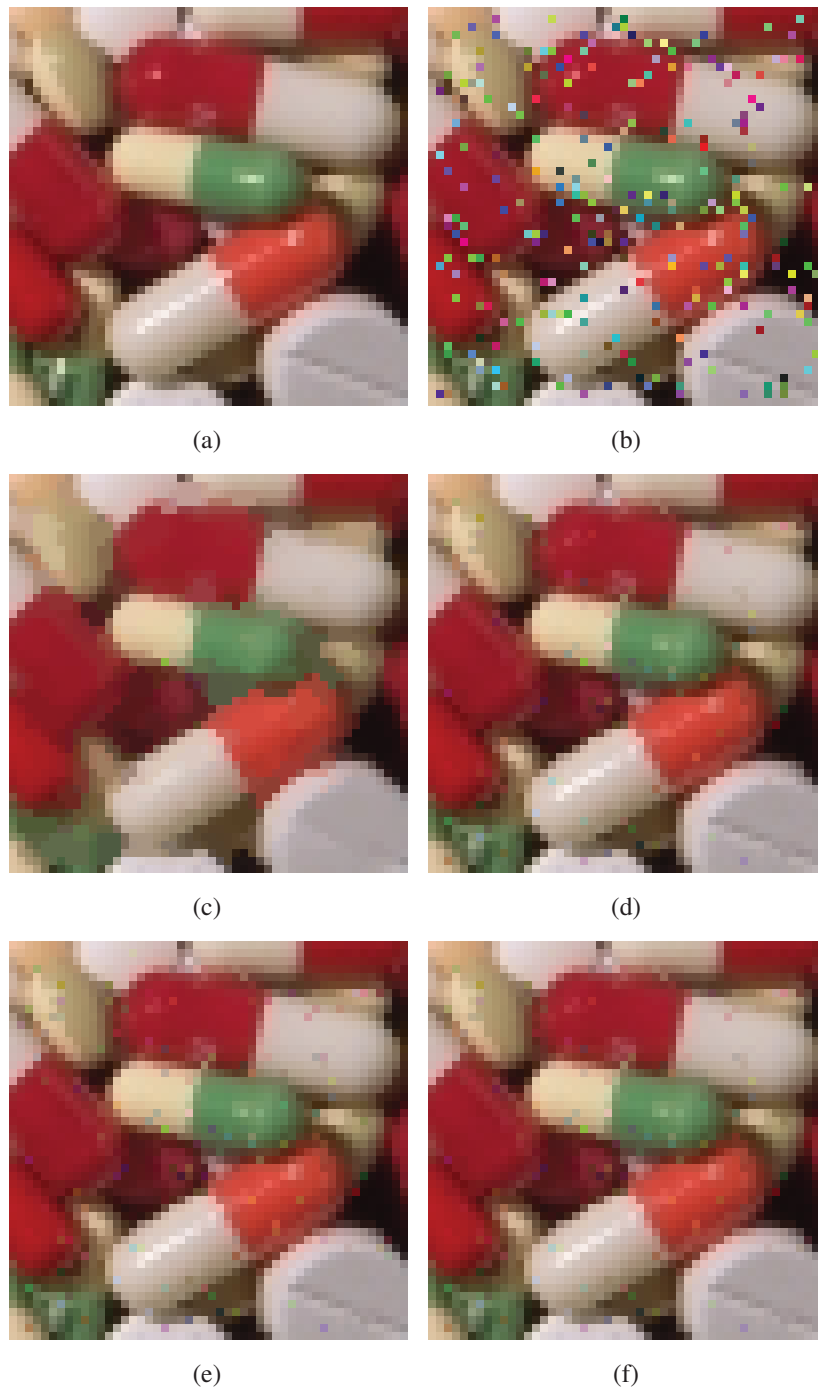
Figura 2.5: Imatges d'eixida: (a) Detall de la imatge Pills original, (b) Detall de la imatge Pills contaminada amb un 10% de soroll impulsu de valor uniforme, (c) Detall de la imatge filtrada amb el Vector Median Filter , (d) Detall de la imatge filtrada amb el Graded Vector Median Filter per als valors òptims K_1 = 54 i K_2 = 166 , (e) Detall de la imatge filtrada amb el Graded Vector Median Filter per als valors K_1 i K_2 en funció del soroll, (f) Detall de la imatge filtrada amb el Graded Vector Median Filter per als valors robustos de K_1 i K_2 proposats.
