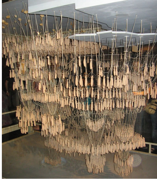
Figure 5. Gaudí's force model of the Colònia Güell in the Sagrada Família Museum (Canaan, 2009).
