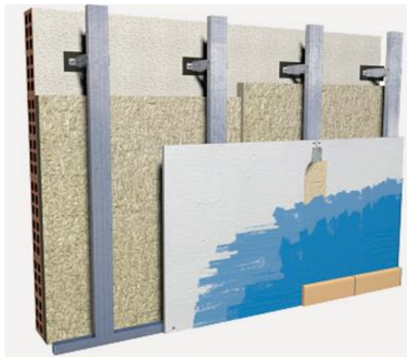
Ilustración 12. Solución aislamiento cerramientos. Fuente: Cype.
