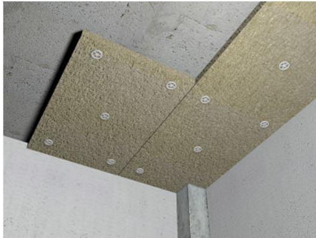
Ilustración 13. Solución aislamiento en techo. Fuente: Cype.
