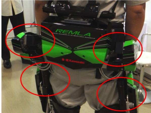
Figura 2.7: Baterías montadas en exoesqueleto[9]
