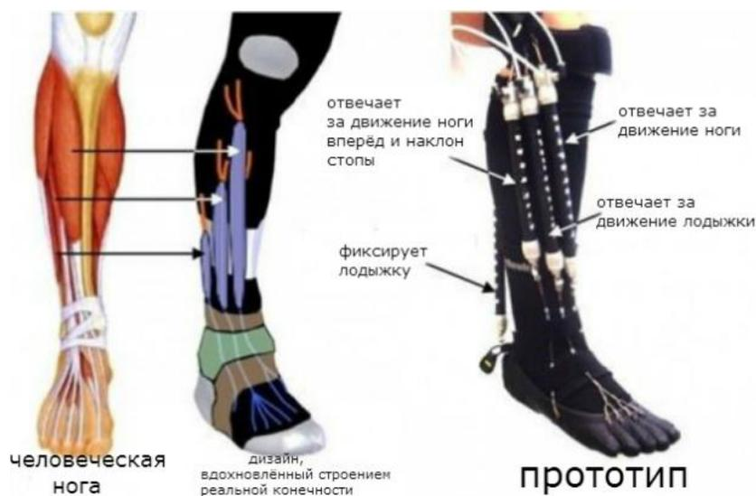
Figura 2.15: Diseño biomecánico de una prótesis robótica[20]
