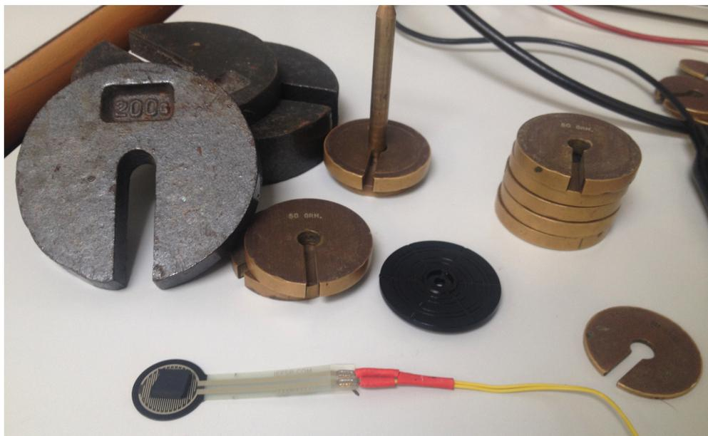
**Figura 3.12:** Conjunto de pesas para pruebas de sensor de fuerza
