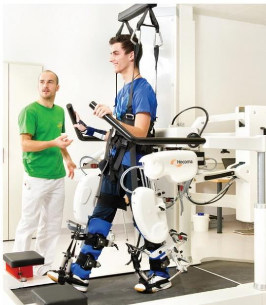
Figura 2.14: Exoesqueleto para rehabilitación[17]
