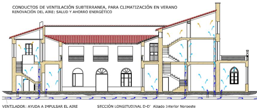
*Figura 71. Esquema de climatización mediante tubos subterráneos. 2014
