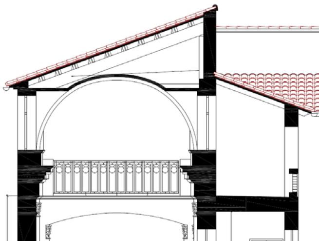
Figura 38. Esquema representativo en sección de la estructura de las cubiertas. Arriba sobre la bóveda de cañón (Escala 1:75) y abajo en la fachada principal (Escala 1:100) . 2014. SANZ GUERRERO, V.
