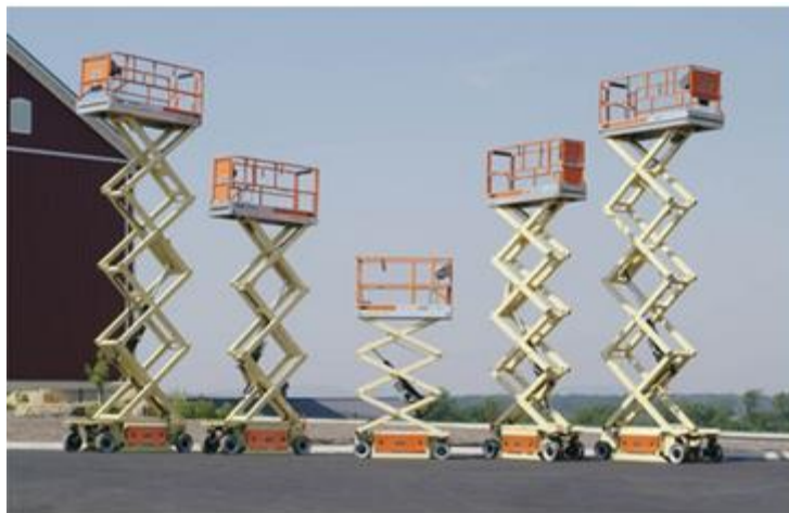
Figura 3. PEMP de tijera autopropulsada. (Fuente “ www.maqlift.com ”).
