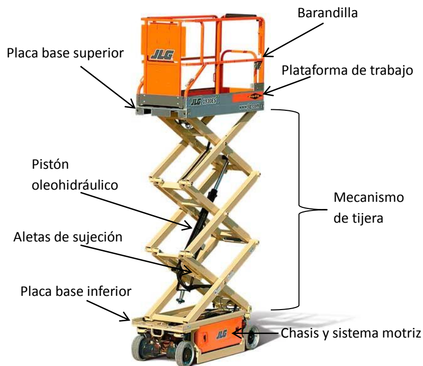
Figura 6. Partes generales PEMP de tijera, modelo 6RS JLG. (Fuente “www.maqlift.com”).
