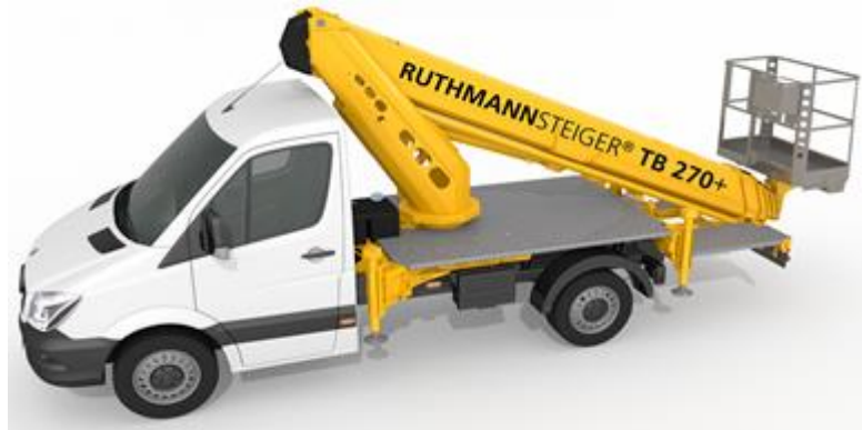
Figura 2. PEMP telescópica sobre camión. (Fuente “ www.ruthmann.de ”).
