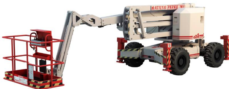
Figura 5. PEMP autopropulsada telescópica. (Fuente "www.industic.es").
