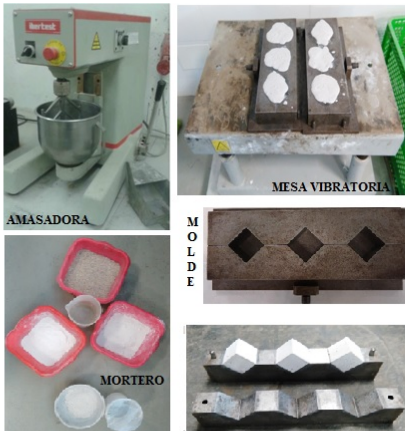
Figura 17 Equipo y materiales usados en la preparación de morteros
