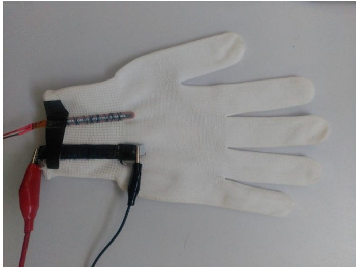
Figura 65. Guante con sensores incorporados
