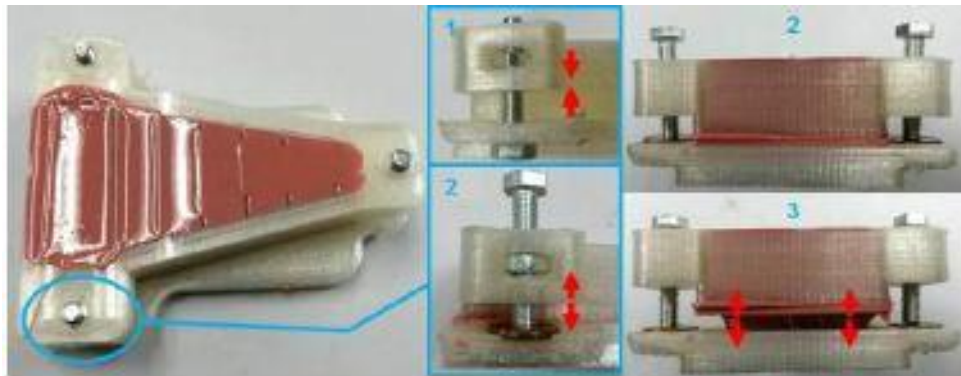
Figura 15. Moldes llenos y desmoldado
