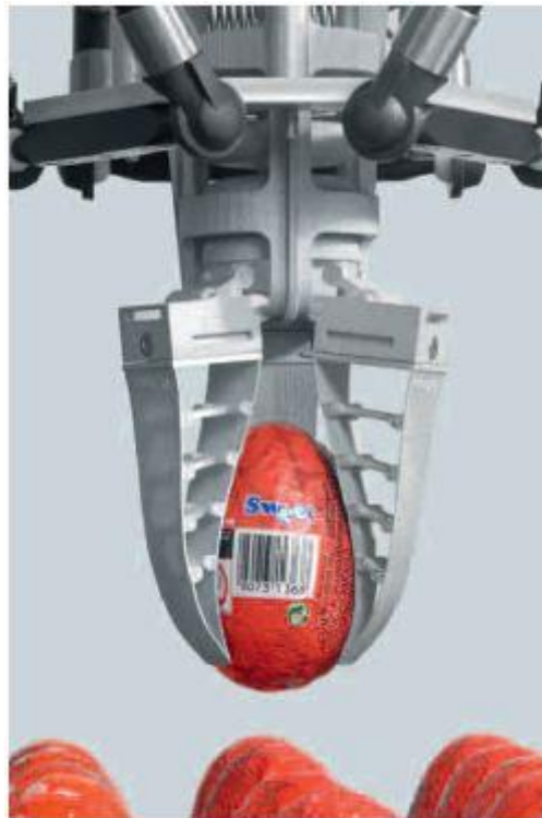
Figura 11. Agarre adaptativo DHDG de FESTO
