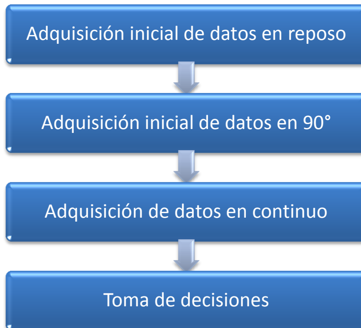
Figura 66. Esquema de funcionamiento del guante
