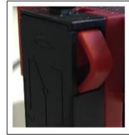
Figura 4.10. Aspecte dels sensors de final de carrera del braç robot
