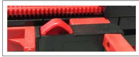
Figura 4.6. Aspecte dels sensors de finals de carrera de la línia de cintes transportadores
