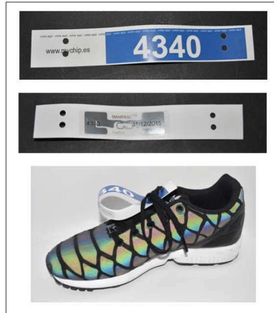
Figura 2.6. Format del xip d'un sol ús utilitzat actualment
