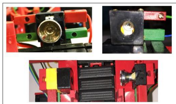
Figura 4.5. Aspecte dels fototransistors de la línia de cintes transportadores
