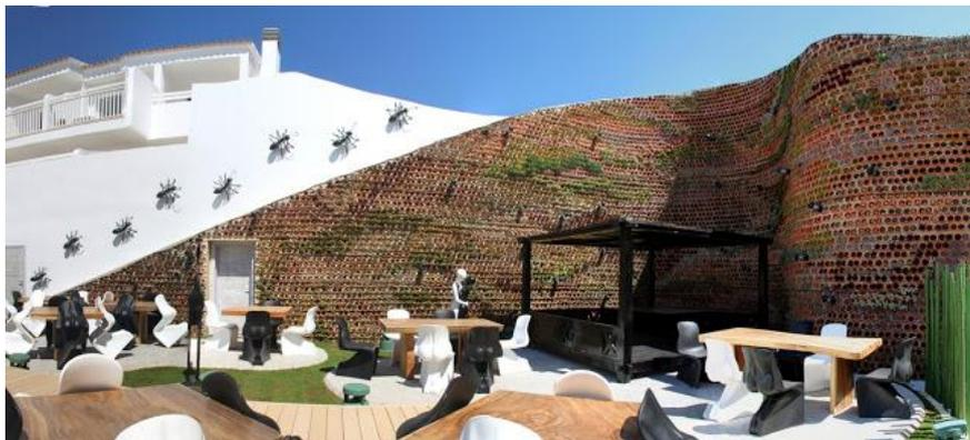
La característica principal del sistema es el medio de plantación, constituido por una fábrica de celdas cerámicas, cuya inclinación junto a la combinación de sustratos específica permite almacenar agua durante un largo periodo de tiempo.
