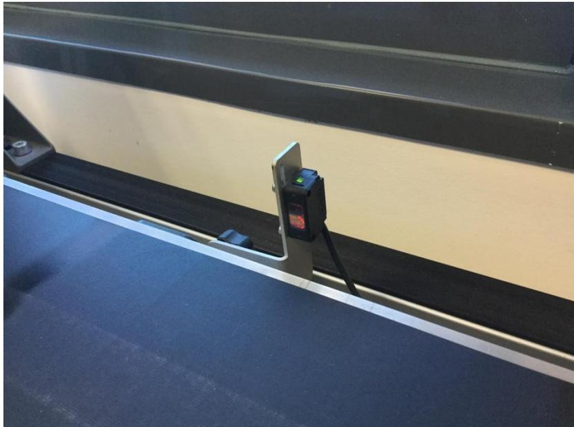
Figura 16: Sensor fotoeléctrico que detecta las piezas en la cinta 3
