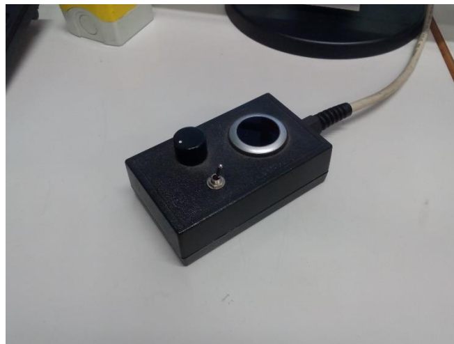
Figura 3.32 Dispositivo con el que se activa y regula la tensión de alimentación de las resistencias.
