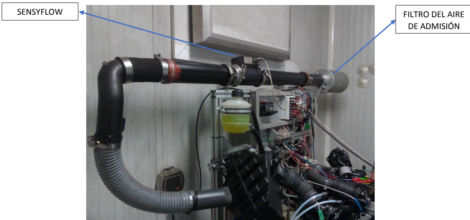
Figura 3.20 Conducto de admisión, Sensyflow y filtro del aire de admisión.
