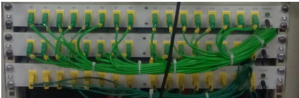
Figura 3.16 Cuadro de conexiones para termopares perteneciente al STARS
