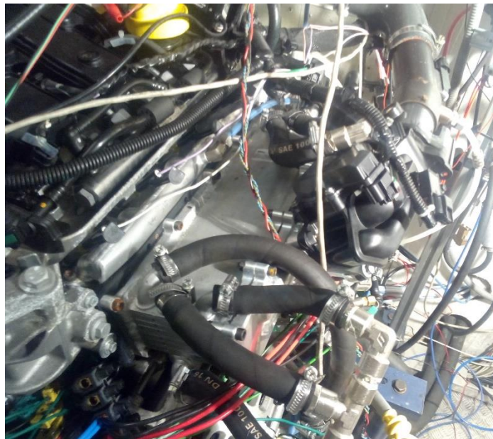
Figura 3.27 WCAC y colector de admisión instalados en el motor.
