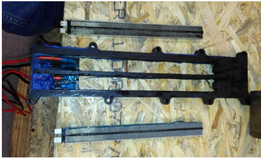
Figura 3.31 Sistema de calentamiento del gas de entrada desmontado.
