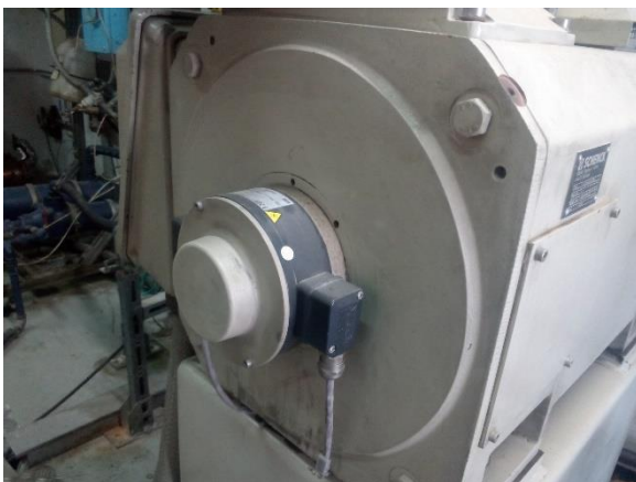
Figura 3.26 Tacómetro empleado para obtener el régimen de giro del motor
